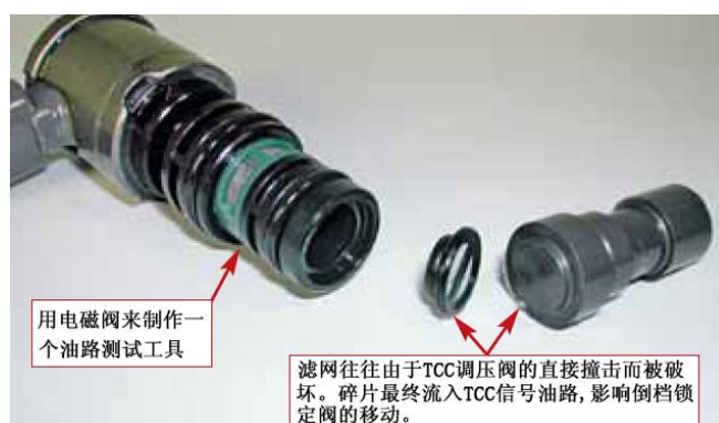
圖 6 改裝電磁閥作為油路測試工具
