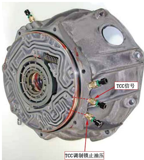
圖 10 鐘殼上的壓力測試點
