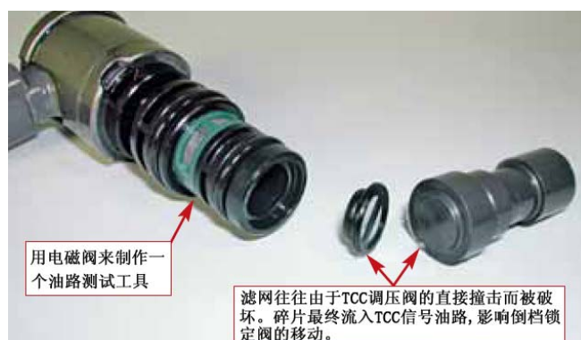
圖 6 改裝電磁閥作為油路測試工具
