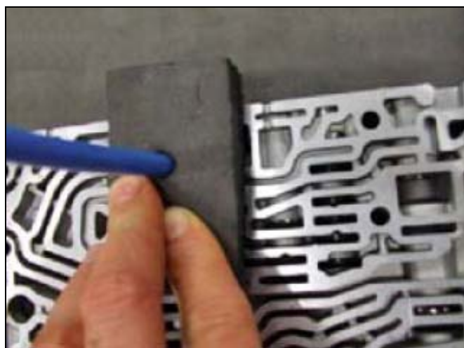
圖 4 對主調壓閥孔進行真空測試
