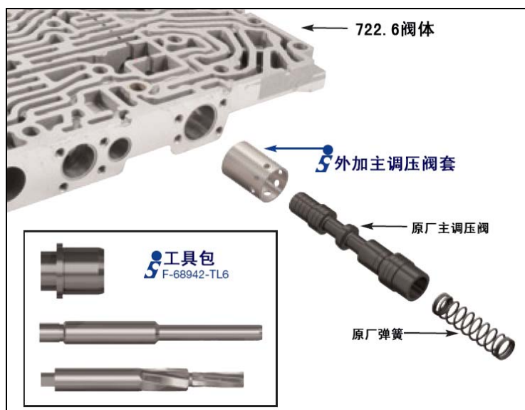
圖 2 通過加入一個硬質襯套來修復主調壓閥孔
