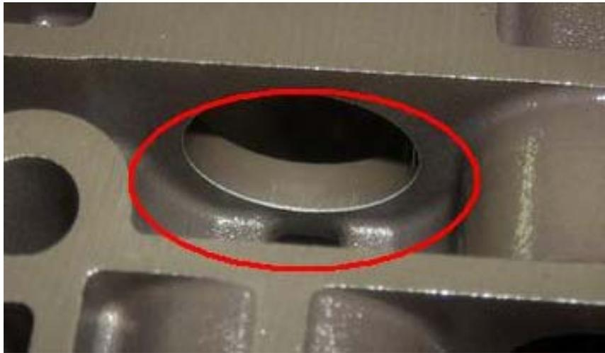
圖 1 被磨損的 AL4/DPO 主調壓閥孔
