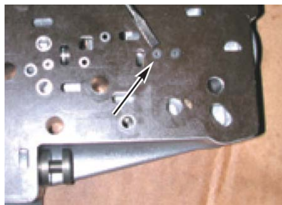
圖 5 隔板上需要堵住的節流孔
